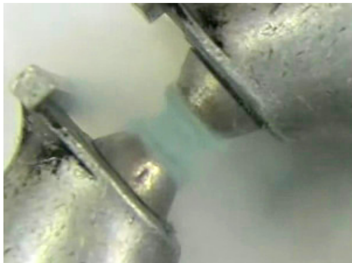
Hình 1. Oxygen lỏng có màu xanh đang bị hút và giữ cố định bởi 2 nam châm.
